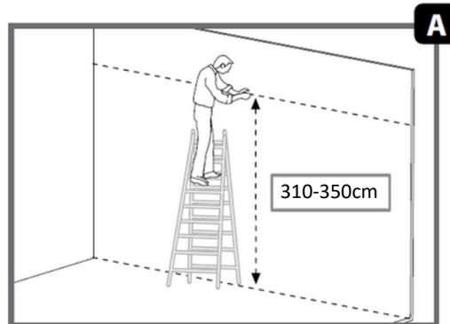
E' anche possibile fissare il profilo ad un'altezza inferiore a **310 cm**. Questo metodo è opzionale. Adottare questa soluzione solo se le condizioni di montaggio e le pareti esterne non consentono di rispettare le istruzioni suggerite e descritte in questo manuale. Si prega di notare che in questo caso l'estetica finale del prodotto può variare.
