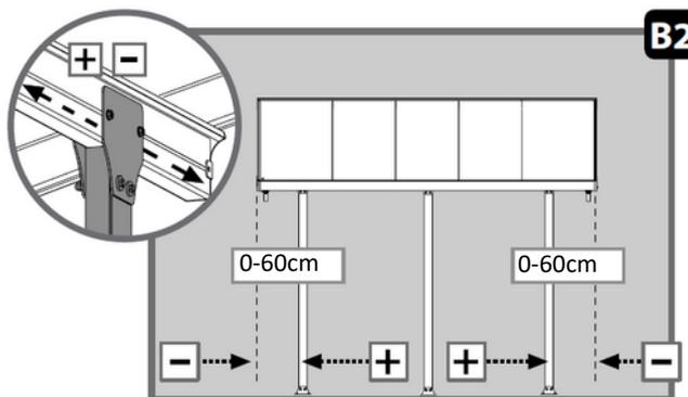
**3)** L'altezza a cui è fissato il profilo posteriore e la distanza dei pali dal muro determinano l'angolo del tetto e la profondità totale della copertura (distanza dalla grondaia al muro). Più alto si monterà il profilo, minore sarà la distanza tra il muro e i pali e quindi la profondità totale della copertura, come illustrato nella **figura C**.
