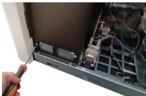
Fig. 86 - Pulizia ventilatore ambiente
