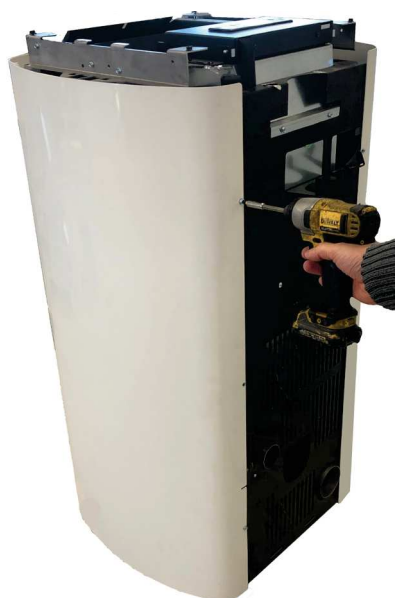
Fig. 47 - Rimuovere viti posteriori
