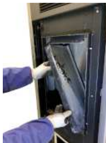
Fig. 94 - Rimuovere le pareti laterali
