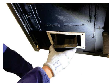
Fig. 99 - Rimuovere il deviatore fumi
