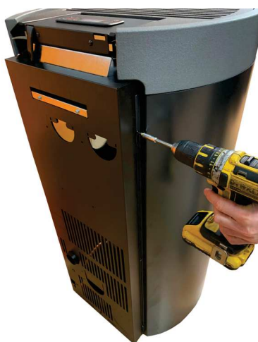
Fig. 32 - Rimuovere viti posteriori
