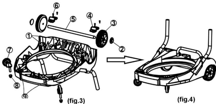
Figg. 3 e 4. Fissare le 2 ruote (7) e i bulloni (8) nella posizione (9)
