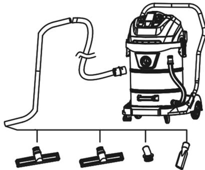
Dopo aver inserito gli accessori desiderati a seconda della funzione (aspirazione liquidi, solidi, pulizia...), inserire la spina in una presa di alimentazione che soddisfi le specifiche sull'etichetta di classificazione (230V/50Hz)
