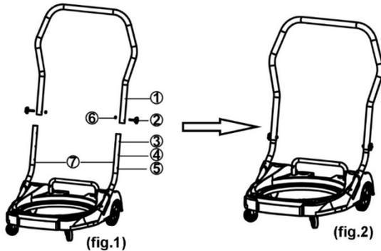
Fig. 1 e 2. Inserire i 2 tubi (3) negli alloggiamenti (5), fissarli quindi con le viti (2) e posizzionarli (1). Usare quindi le viti per fissare i tubi (4) e (6).
