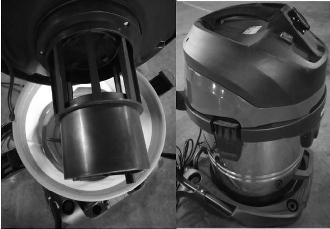
Riposizionare il blocco motore sul contenitore in acciaio e chiudere le 2 clip laterali accuratamente.
