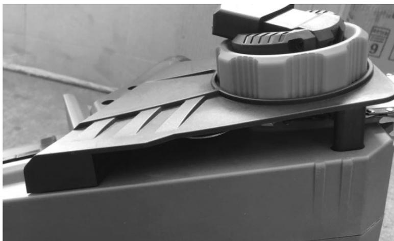
E' ora necessario girare la manopola in senso orario per fornire la corretta tensione alla catena. La corretta tensione deve lasciare uno spazio minimo tra barra e catena come nell'ultima immagine in sequenza.
