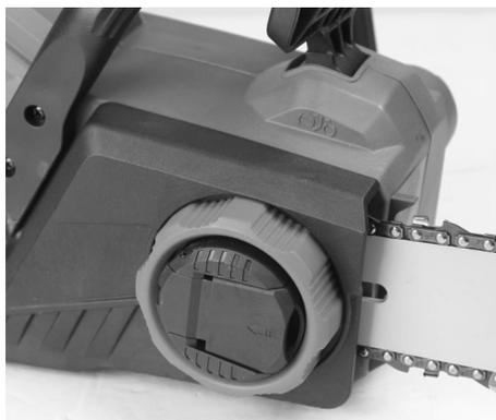
Come ultima verifica, controllare il verso di montaggio della catena ed esercitare una leggera pressione sulla barra: non deve esservi movimento verso il basso: controllare la sequenza di montaggio della barra se necessario.
