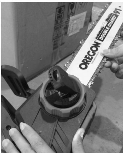
A questo punto ruotare la leva in senso orario fino alla corretta sistemazione nell'alloggiamento.
