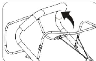
**!** **NOTE** : Se il motore non si avvia dopo tre tentativi, ripetere la procedura.4. Una volta avviato il motore, inserire la fune di avviamento nella guida della fune, come mostrato nella Fig. 16
