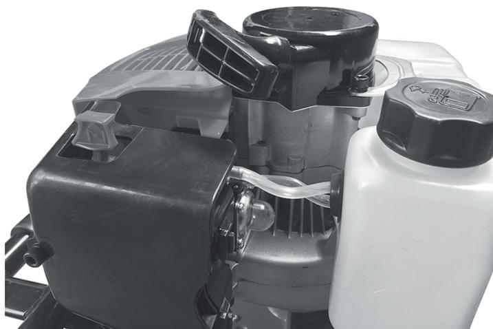
Se si è eseguito un avviamento a freddo, dopo una decina di secondi (o più, in caso di necessità) riportare la leva dell'aria in posizione RUN. Se il numero di giri non si stabilizzasse e il motore tendesse a spegnersi, riportare ancora per qualche secondo le leva in posizione START, quindi riprovare a riportarla in posizione RUN.
