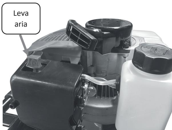
Avviamento a freddo: posizionare la leva dell'aria in posizione START (vedere figura soprastante). Aprendosi, arricchirà la miscela del carburatore.
