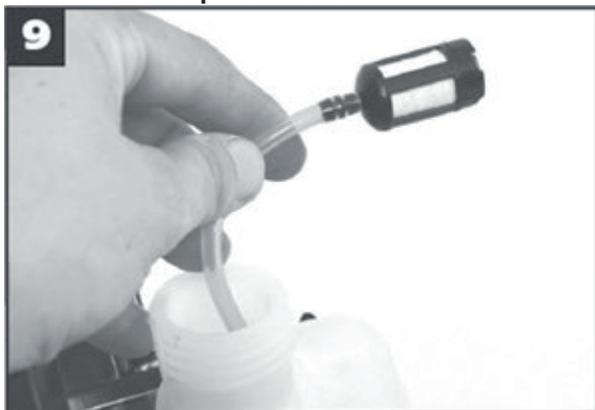
Il filtro carburante può con il tempo intasarsi. Per pulirlo o sostituirlo, estrarlo dal serbatoio carburante dopo aver svitato il tappo tramite un attrezzo a gancio.
