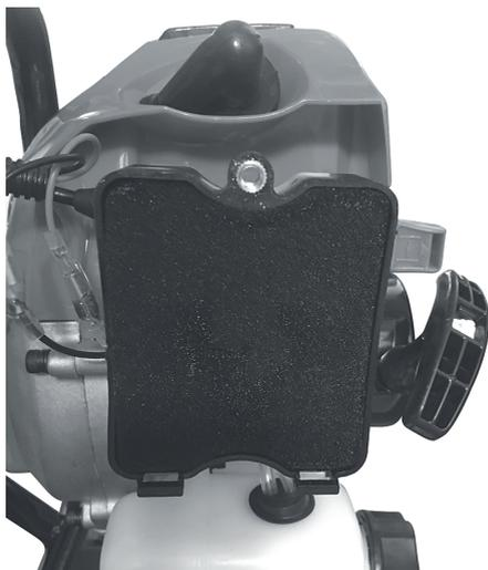
Pulire le eventuali impurità presenti all'interno dell'alloggiamento del filtro con un panno umido e pulito. Riposizionare il filtro spugnoso e richiudere il coperchio del filtro aria.
