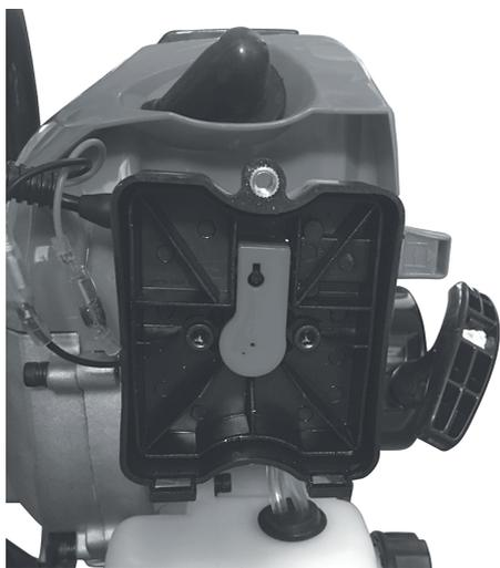
Rimuovere il filtro spugnoso e controllare l'integrità. Se danneggiato, sostituirlo.
