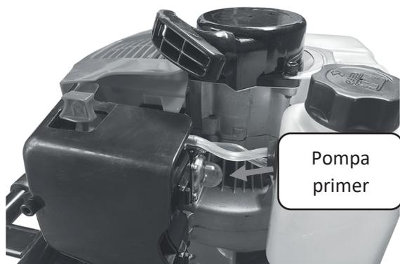
Premere la pompa primer il numero di volte necessario a vedere l'obolo semitrasparente e i tubi soprastanti pieni di miscela.
