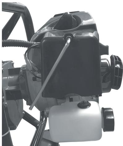
Allentare le viti sulla scatola del filtro. Rimuovere il filtro dell'aria e controllarlo.
