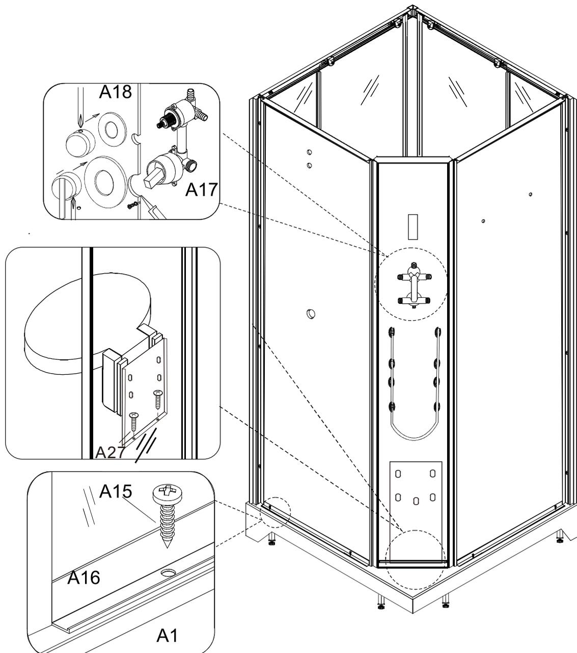
**7° PASSAGGIO:** Montare la copertura (A20) fissandola ai vetri posteriori (A16) con le viti autofilettanti fornite (A15). Montare successivamente il supporto doccia (A23) con i bulloni in dotazione (A24), la doccetta (A26) al flessibile (A28), la mensola (A21) e il flessibile (A25) all'attacco (A19).
