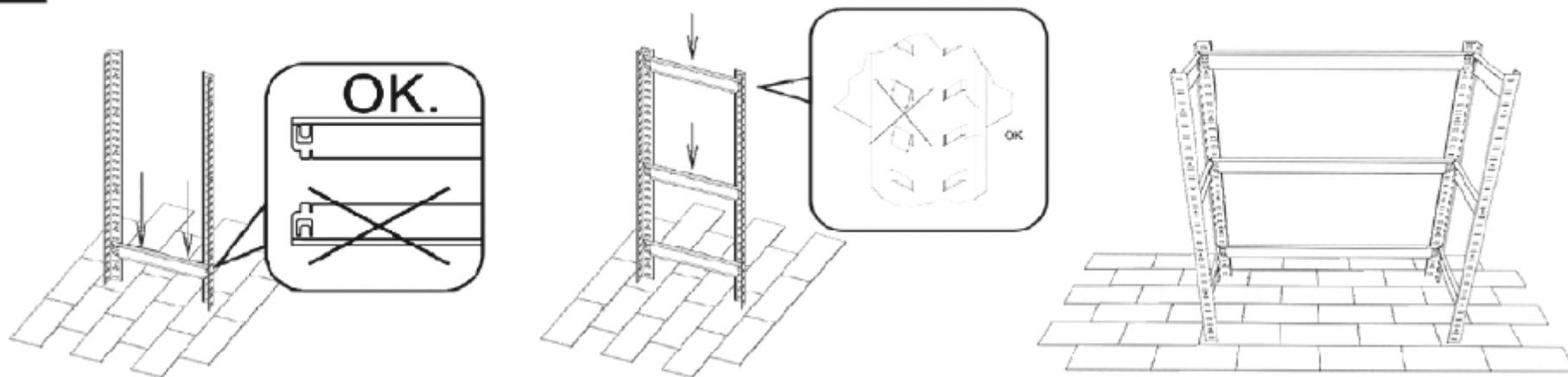
**2^ PASSAGGIO:** Inserire completamente le barre orizzontali nelle barre verticali aiutandosi con un martelletto. Verificare che le barre verticali siano incastrate come da immagine allegata. Procedere poi con il montaggio delle barre di rinforzo come da disegno allegato:
