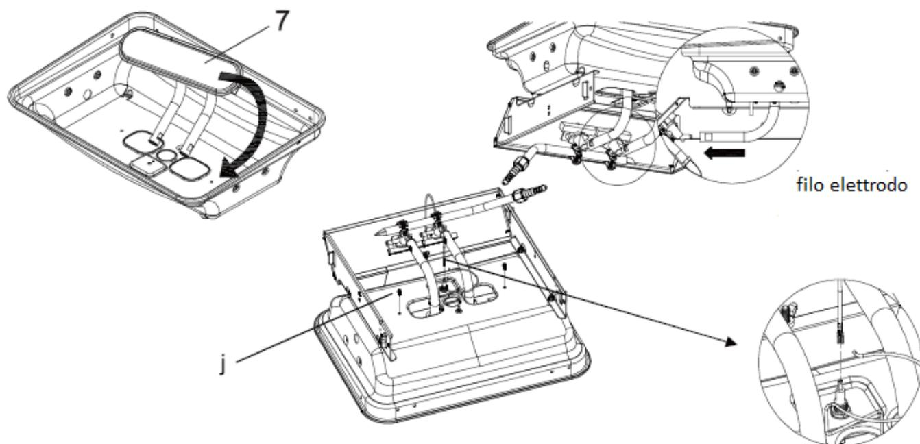
**7^ PASSAGGIO:** installare la cerniera (3B) sul braciere e il supporto controllo fiamme (6) con la viteria in dotazione (A + B + C). Successivamente montare le manopole di accensione (13).
