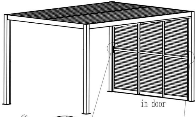
Diagramma schematico di installazione della maniglia per tre pannelli.
