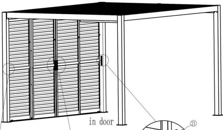
Diagramma schematico di installazione della maniglia per quattro pannelli.
