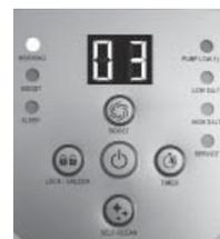
**NOTA:** Se si dimentica di bloccare di nuovo i controlli del pannello a pulsanti, il sistema ad acqua salata bloccherà automaticamente i controlli del pannello e comincerà a funzionare 1 minuti dopo.
