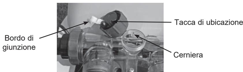
3. Se il getto d'acqua non riesce a rimuovere i depositi, utilizzare una spazzola di plastica, per pulire la superficie e, se necessario, anche la cerniera. Non utilizzare una spazzola con punte metalliche.
