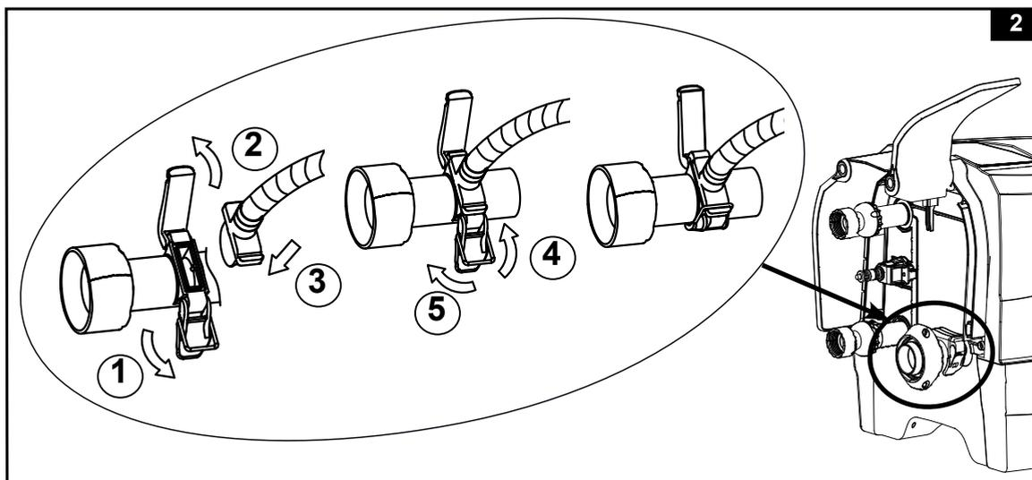
3. Svitare il coperchio della valvola dell'aria sulla vasca della spa per accedere allo stelo, nella posizione verticale di gonfiaggio. Inserire l'altra estremità del tubo (7) nella valvola e ruotarlo verso destra per bloccarlo in posizione (vedi disegno 3).
