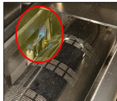
4. Rilasciare la manopola di comando. Il bruciatore del forno è ora acceso a fiamma alta e puoi preriscaldare il forno. Chiudi la bocca del forno con lo sportello e attendi il tempo necessario (es. 30/50 minuti) che le pietre refrattarie del piano cottura si scaldino fino a raggiungere la temperatura desiderata.
