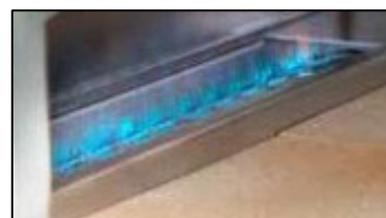
4. Rilasciare la manopola di comando. Il bruciatore del forno è acceso a fiamma alta e puoi preriscaldare il forno. Chiudi la bocca del forno con lo sportello e attendi il tempo necessario (es. 30/50 minuti) che le pietre refrattarie del piano cottura si scaldino fino a raggiungere la temperatura desiderata.
