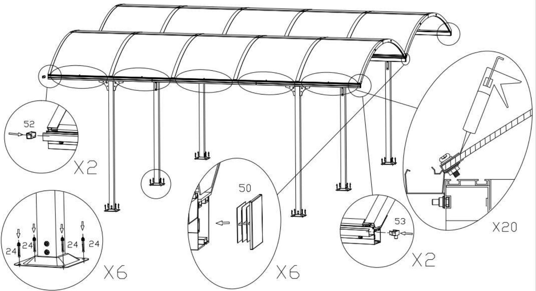
Pour maximiser l'étanchéité des gouttières, appliquer un mastic d'étanchéité d'extérieur (non fourni) à toutes les pièces en contact.
