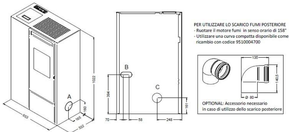
A = Ø 80 mm Scarico fumi laterale / Flue lateral / Haut de Fumée / Seitlich Abgasstutzen / Salida humos lateral / Descarga de fumos lateral
