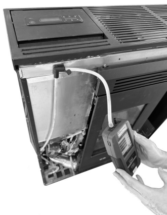
Fig. 57 - Collegamento pressostato digitale
