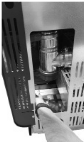
Fig. 48 - Inserire tubo flessibile
