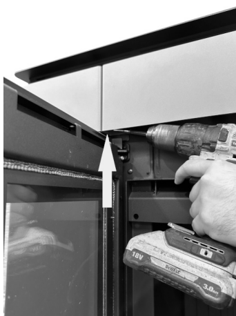
Fig. 32 - Rimuovere la vite di sicurezza
