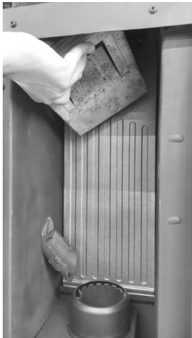
Fig. 66 - Rimuovere la testa del focolare 1
