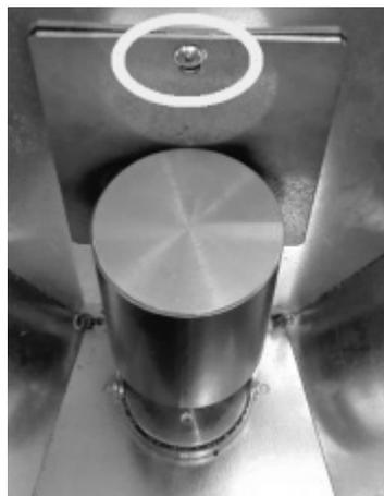
*Fig. 63 - Rimozione vite*
