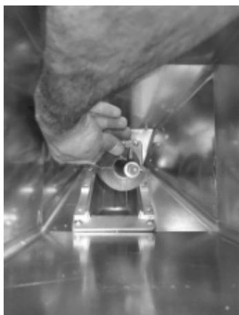
**Fig. 51 - Rimozione spirale**
