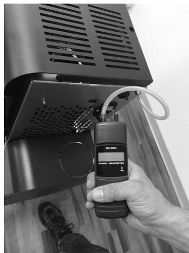
Fig. 47 - Collegamento pressostato digitale
