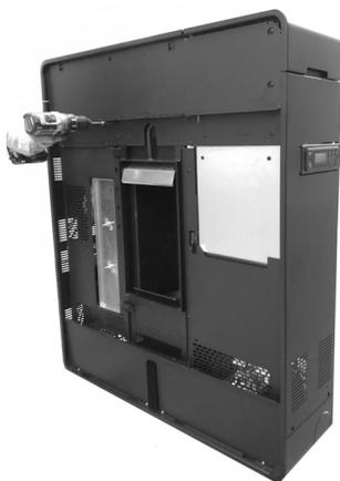
**Fig. 33 - Smontaggio staffa superiore**
