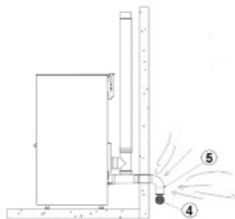
Fig. 8 - Presa d'aria per installazione a camera stagna
