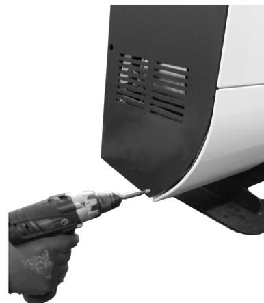
**Fig. 30 - Fissaggio inferiore pannelli**
