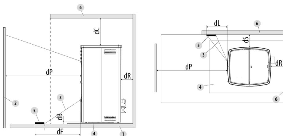
Fig. 15 - Distanze di sicurezza da materiale combustibile
