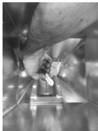
**Fig. 52 - Rimozione cuscinetto**
