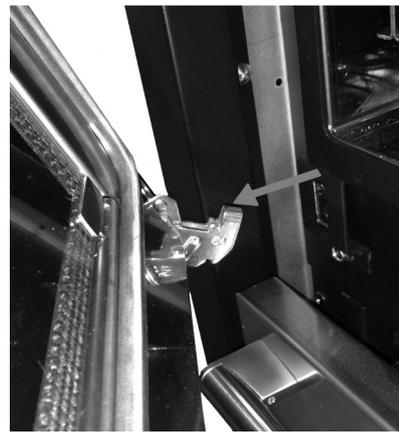
Fig. 52 - Rimozione porta forno
