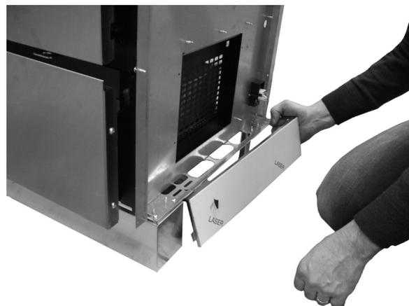
**Fig. 37 - Rimozione zoccolo**
