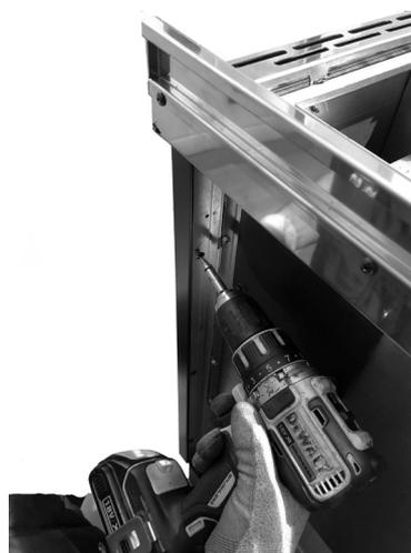
**Fig. 41 - Fissare i fianchi su 3 viti**
