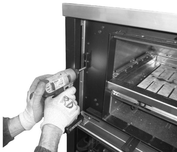
**Fig. 29 - Fissare supporto**
