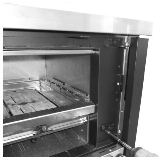
**Fig. 27 - Fissare staffa inferiore**
