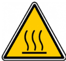
Fig. 1 - Attenzione: superfici calde!
