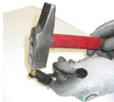
Fig. 25 - Inserire perno al contrario
