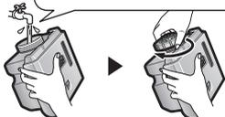
Serrare saldamente il tappo sul serbatoio dell'acqua. In caso contrario, si potrebbero verificare delle perdite d'acqua.
