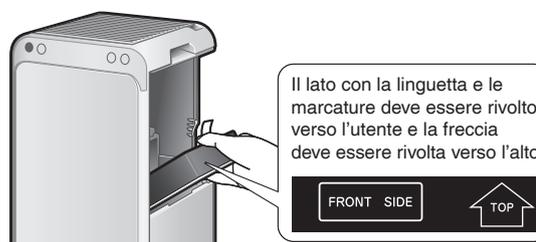
**6. Installare l'unità di filtrazione e deodorizzazione nell'unità principale.**
