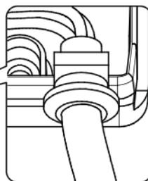
Controllare che il cavo di connessione sia saldamente assicurato.
