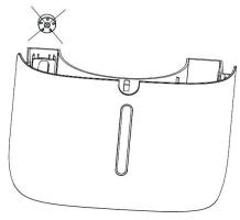
Se il serbatoio è sporco, pulirlo con acqua fredda o calda. Non utilizzare detergenti, lana d'acciaio, o un panno per la rimozione della polvere, agenti chimici, benzina, benzene, diluenti o altri solventi, perché potrebbero danneggiare il serbatoio dell'acqua e causare perdite d'acqua.
