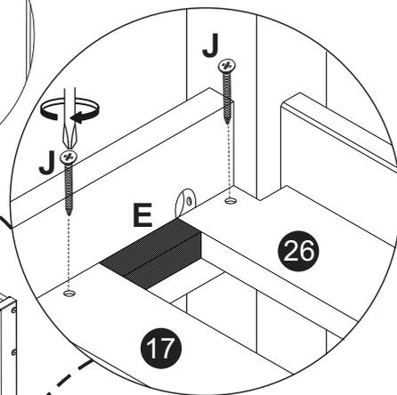
Fissare per prima la doga centrale in modo che si incastri perfettamente nella struttura del letto. Procedere con le doghe restanti posizionandole sui supporti presenti nel telaio. Procedere con l'avvitamento.
