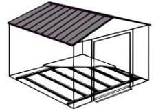
Un semplice sistema di telaio per pavimento realizzato in robusto acciaio zincato a caldo. Utilizzato come base per compensato, sabbia o pietra.
