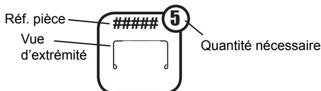
Au sommet de chaque page se trouvent un ou plusieurs **indicateurs de pièces** semblables à celui représenté à gauche. Ces **indicateurs de pièces** servent à identifier rapidement les pièces nécessaires pour chaque étape.
