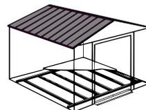
Un système de cadre de plancher simple en robuste acier galvanisé par immersion à chaud. S'utilise comme base pour le contreplaqué, le sable ou la pierre.
