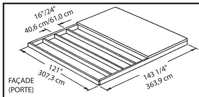
**Note :** La plate-forme ou la dalle dépassera de 1,4 cm (9/16") le cadre de plancher sur les quatre côtés. Pour une plate-forme en bois, scellez ce surplomb de 1,4 cm (9/16") avec du ciment pour toiture (non fourni). Pour une dalle en béton, biseautez ce surplomb de 1,4 cm (9/16") quand vous coulerez le béton. Vous assurerez ainsi un bon écoulement des eaux.
