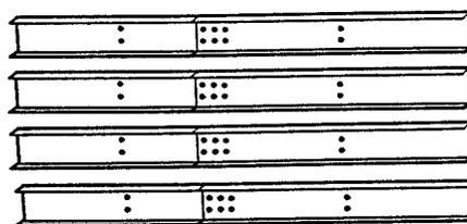
2 Prendre deux des poutres de toit pressées ensemble et les réunir comme illustré de manière à former l'ensemble de poutre de toit principal. Tenir l'ensemble réuni et fixer à l'aide de 14 boulons. Réaliser un seul ensemble de poutre double.
