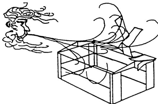
• Ne tentez pas de monter l'abri par un jour de vent parce que les grands panneaux faisant fonction de "voile" peuvent être fouettés par le vent, rendant ainsi la construction difficile et dangereuse.
