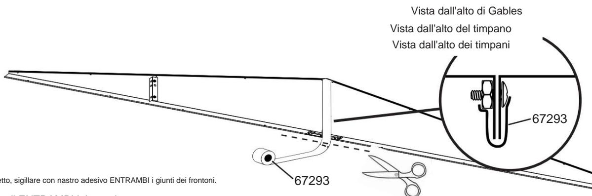
Prima di installare le travi del tetto, sigillare con nastro adesivo ENTRAMBI i giunti dei frontoni.
