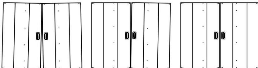
Se le porte non sono allineate, alzare o abbassare un lato della porta inserendo le viti della porta in un diverso set di fori nella guida della porta.
