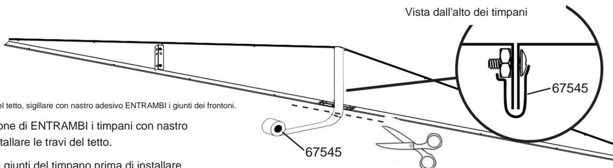
Prima di installare le travi del tetto, sigillare con nastro adesivo ENTRAMBI i giunti dei frontoni.
