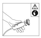
Pericolo di vibrazioni elevate. Indossate i guanti antivibrazione. Effettuate delle pause di riposo durante la lavorazione.
