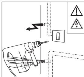
Rischio di folgorazione o esplosione a causa di forature di canalette elettriche o tubazioni con fluidi in pressione (acqua, gas...). Impugnare con entrambe le mani le 2 impugnature isolate dell'utensile. Utilizzare un rilevatore di parti metalliche nascoste.
