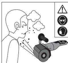
Lancio di materiale e scintille verso gli occhi ed il corpo dell'operatore. Indossate occhiali di protezione e maschera antipolvere.
