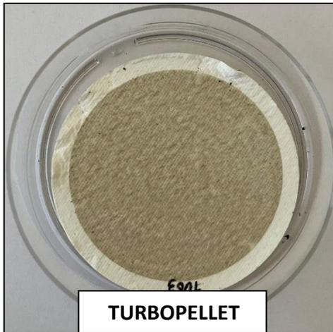
Filtro ottenuto dopo i test eseguiti su Turbopellet per misurare l'emissione di polveri sottili.
