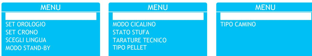
Mediante i tasti **+/-** è possibile scorrere le varie voci; per selezionarne una, premere il tasto **OK**. Vediamole in dettaglio qui di seguito, nell'ordine di apparizione:
