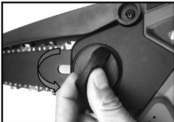
2. Regolare la tensione della catena. Ruotare la vite a testa della catena in senso orario per stringere, ruotarla in senso antiorario per allentare. Per verificare la corretta tensione della catena di taglio, tirare la catena della sega con una forza di circa 1 kg, se c'è una distanza di 3-4 mm tra il centro del lato inferiore della barra di guida e la catena della sega come mostrato di seguito, la tensione è adeguata.
