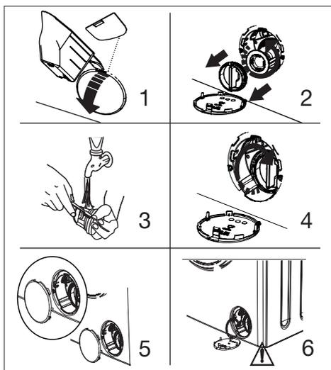
Il sistema di filtraggio della pompa nella lavatrice prolunga la vita della pompa impedendo alla lanuggine (accumulo di pelucchi) di entrare nella macchina. Si consiglia di pulire il filtro della pompa ogni 2 mesi, in particolare:
