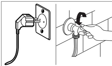
Prima di eseguire la manutenzione e la pulizia dell'apparecchio disattivare l'alimentazione elettrica e rimuovere la spina dalla presa. Chiudere l'erogazione idrica prima di iniziare la manutenzione e la pulizia della macchina.
