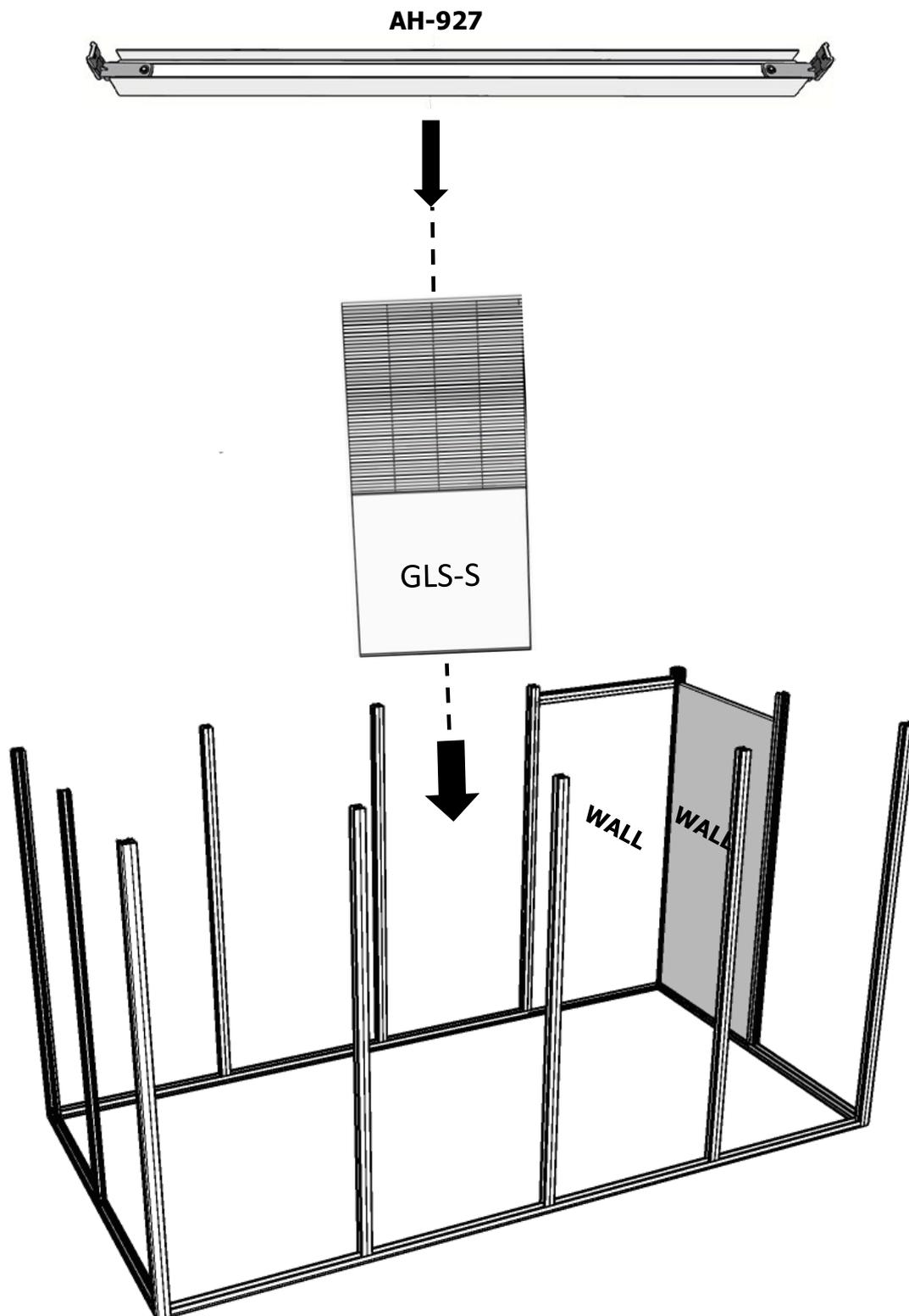
Montaggio illustrato su modello casetta 4x2 - EVSHED4x2AN
