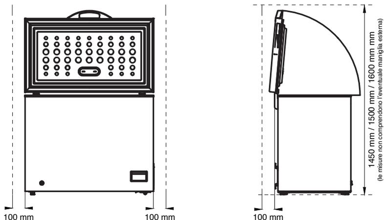
Appoggiate l'apparecchio su un pavimento solido in grado di sopportarne il peso anche quando è pieno. Evitate di appoggiare l'apparecchio su materiali elastici e risonanti che ne amplificherebbero il rumore.
