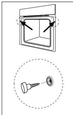
Accertarsi che il telaio del forno e il bordo anteriore dell'arredo corrispondano uniformemente.
