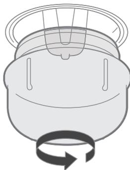
**AVVERTENZA:** Per evitare scosse elettriche, accertarsi che il circuito dell'apparecchio sia aperto prima della sostituzione della lampadina (aprire il circuito significa staccare l'alimentazione): spegnere l'apparecchio mediante i comandi sul pannello di controllo e scollegare il cavo di alimentazione. Verificare la tipologia di lampadina necessaria prima di provvedere alla sostituzione.
