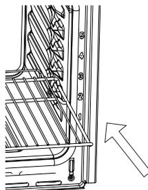
È importante posizionare correttamente la griglia metallica nel forno. Evitare che la griglia metallica tocchi la parete posteriore del forno. Le teglie possono essere posizionate tra il primo e il quinto ripiano, come mostrato nelle figure qui sopra. È possibile posizionare un vassoio profondo o un vassoio standard nei ripiani a filo inferiore e superiore.
