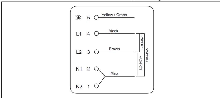
Se il numero totale di unità riscaldanti dell'apparecchio scelto non è inferiore a 4, l'apparecchio può essere collegato direttamente alla rete elettrica tramite un collegamento elettrico monofase, come mostrato di seguito.
