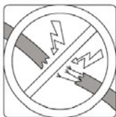
Controleer op beschadigde bedrading
