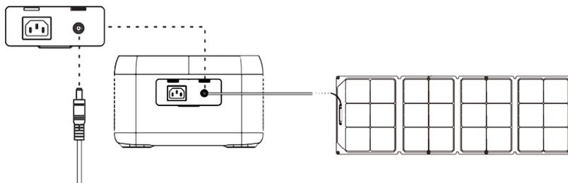
Caricare la stazione di alimentazione tramite pannello solare.
