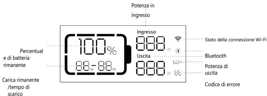
**Capacità della batteria:** Quando la stazione di alimentazione è in carica, l'icona SOC lampeggerà.
