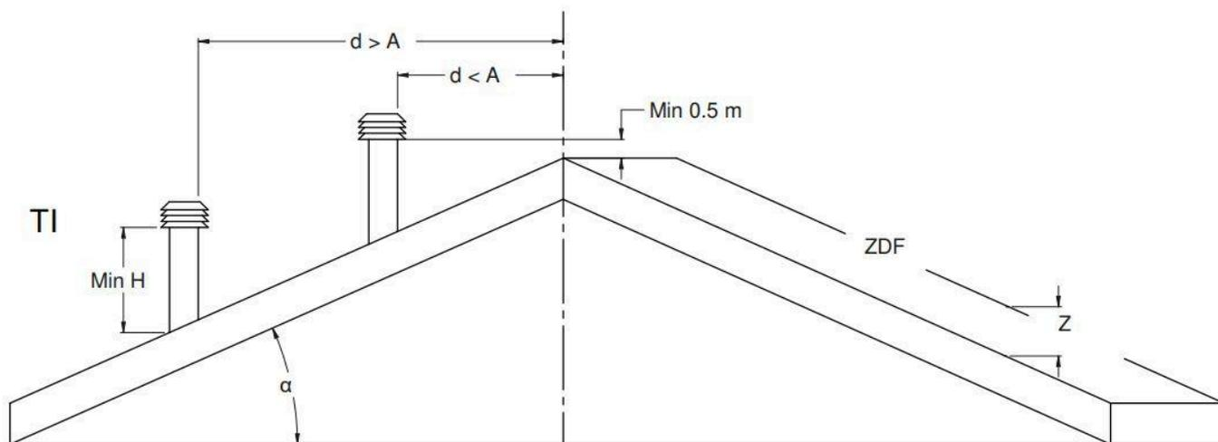
Legenda: TP - tetto piano; TI - tetto inclinato; d - distanza; ZDF - zona di reflusso
