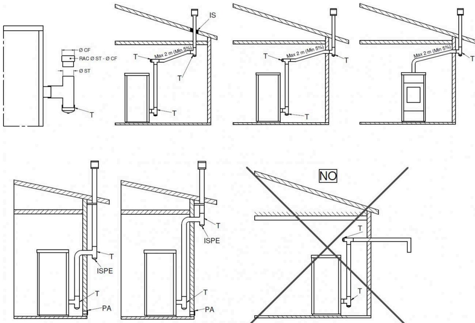
Legenda: T - Raccordo a T; Ø ST - Diametro T stufa; RAC Ø ST Ø CF - Raccordo stufa e canale da fumo; Ø CF - Diametro canale da fumo; IS - Isolante; ISPE - Ispezione; PA - Presa d'aria esterna
