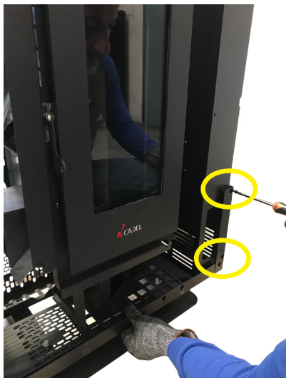
Fig. 41 - Fissaggio staffa inferiore
