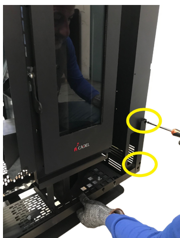
Fig. 34 - Fissaggio staffa inferiore
