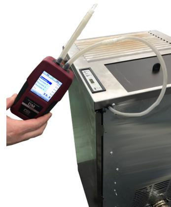
Fig. 20 - Collegamento pressostato digitale 1
