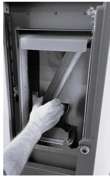
**Fig. 24 - Rimuovere le pareti laterali del focolare**
