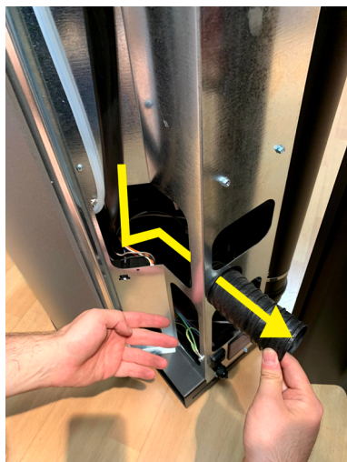
Fig. 59 - Passaggio tubo flessibile 1
