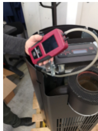
Fig. 66 - Collegamento pressostato digitale 2
