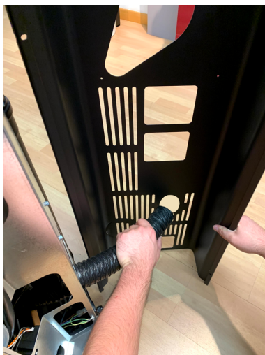
Fig. 60 - Passaggio tubo flessibile 2
