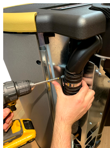
Fig. 58 - Sfilare tubo flessibile
