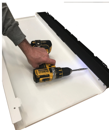
Fig. 39 - Fissare il fianco colorato
