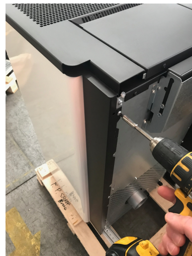
Fig. 40 - Fissare il fianco completo
