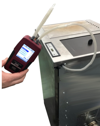
Fig. 65 - Collegamento pressostato digitale 1
