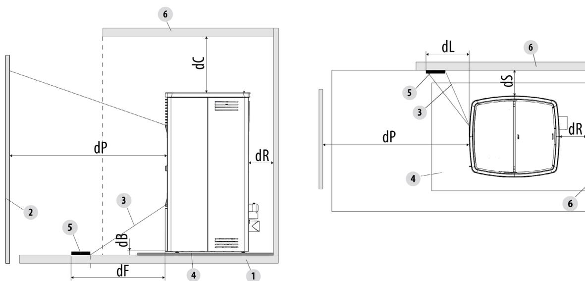
Fig. 11 - Distanze di sicurezza da materiale combustibile
