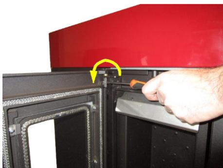
Fig. 19 - Rimozione viti
