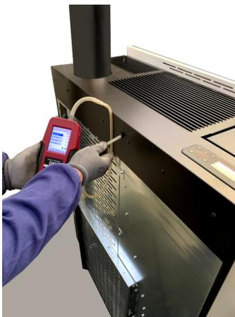
Fig. 109 - Collegamento pressostato digitale (Mithos)
