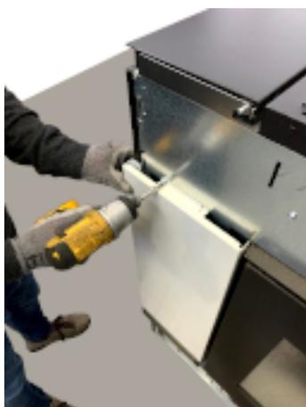
*Fig. 39 - Fissare pannelli laterali*
