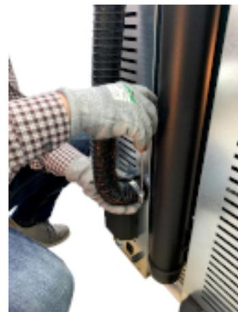
Fig. 75 - Innestare tubo dell'aria comburente
