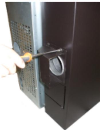
**Fig. 88 - Montaggio diffusore**
