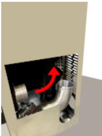
*Fig. 100 - Ruotare il tubo flessibile*
