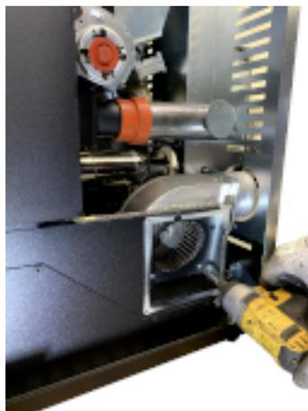
**Fig. 81 - Rimuovere viti ventilatore**
