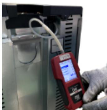
**Fig. 108 - Collegamento pressostato digitale (Atena - Duke)**
