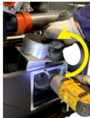
**Fig. 82 - Ruotare ventilatore**
