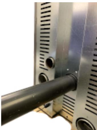
**Fig. 67 - Collagare il tubo di scarico**
