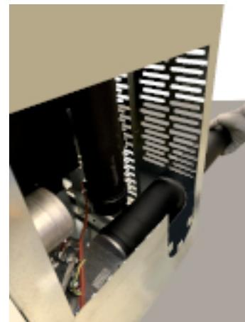
*Fig. 98 - Collegare il tubo canalizzazione*
