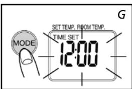
**1** Tryk på mode-knappen **18** for at indstille tiden (fig. G). Time set samt klokkeslættet blinker på displayet.
