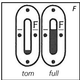
**5** Kontrollera den avtagbara bränsletankens bränslemätare medan du fyller bränsletanken (fig. F). Avbryt påfyllningen när mätaren indikerar att bränsletanken är full. Överskrid inte gränsen för hur mycket bränsle som kan fyllas på, särskilt inte om bränslet är mycket kallt (bränslet utvidgas när det blir varmt).
