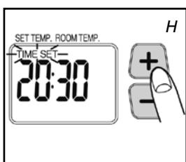
**2** S pritiskom na gumba (-) ali (+) **19** nastavite čas. Ura prikazuje številke od 0:00 do 23:59. Za naprej pritisnite gumb (+), za nazaj pa gumb (-). Vsakič ko pritisnete enega od teh 2 gumbov, se čas spremeni za eno minuto. Če gumb držite neprekiniteno, se čas na zaslonu spreminja po 10 minut (slika H).
