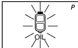
Če ne ukrepatе, se posoda z gorivom izprazni, na zaslonu pa se prikaže „E 03“ (slika Q). Peč se samodejno izključi.
