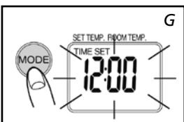
**1** Nacisnąć klawisz wybierania trybu **18** w celu ustawienia czasu (rys. G). Na wyświetlaczu miga czas ustawiony oraz czas.
