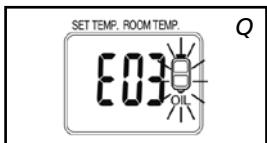
Para ligar novamente o aquecedor, encha o tanque e aguarde alguns minutos. Em seguida, pressione o botão ON / OFF 20.
