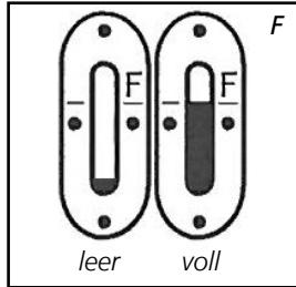
den Füllvorgang ein. Den Tank niemals zu voll füllen. Vor allem nicht, wenn der Brennstoff sehr kalt ist (Brennstoff dehnt sich aus, wenn er wärmer wird).
