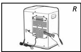
**Limpe o filtro do ventilador (Fig. R).**
