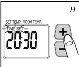
**2** Tryk på knapperne (-) eller (+) **19** for at indstille tiden. Tiden viser tallene 00:00 til 23:59. Tryk på knappen (+) for at gå fremad og knappen (-) for at gå tilbage. Klokkeslættet ændres i trin på et minut, hver gang du trykker på en af disse 2 knapper. Tiden på displayet ændres i trin på ti minutter, hvis du holder knappen nede (fig. H).
