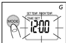
**1** Premere il pulsante mode **18** per la regolazione dell'ora. (la spia della regolazione dell'ora e il display dell'orologio lampeggiano) (fig. G).
