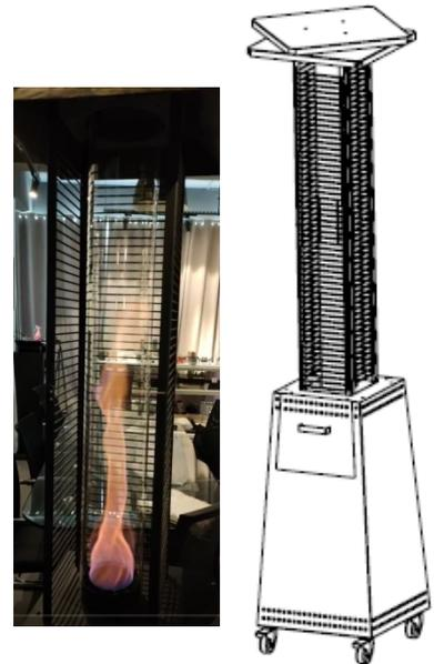
**DESCRIZIONE PRODOTTO:** Fungo in acciaio verniciato. Due tubi in vetro ceramico, lunghi 45 cm cad. (diametro 12 cm – spessore vetro 4 mm), ospitano la fiamma di oltre 70 cm di altezza. Il traliccio è apribile per consentire la pulizia del tubo in vetro, dopo averlo rimosso con cautela.
